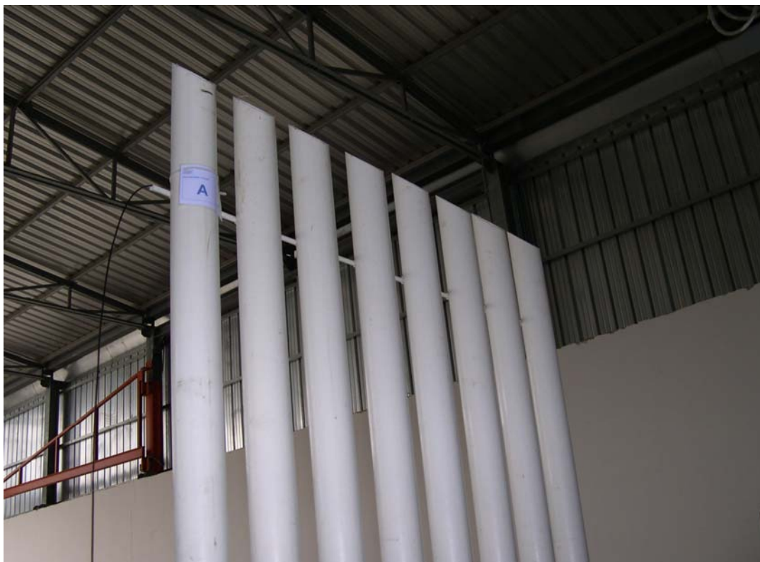
Foto 4: vista della tipologia della nuova recinzione con i pali in vetroresina che verranno tinteggiati di verde.
