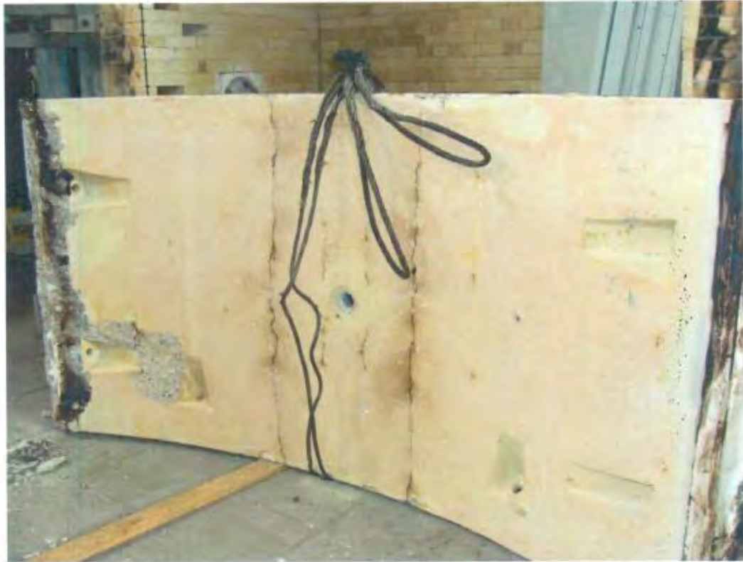
Рис. 7. Опытный образец № 2 после огневого воздействия, вид на обогреваемую сторону, значительных повреждений защитного слоя бетона не зафиксировано, видны поперечные нитевидные трещины
