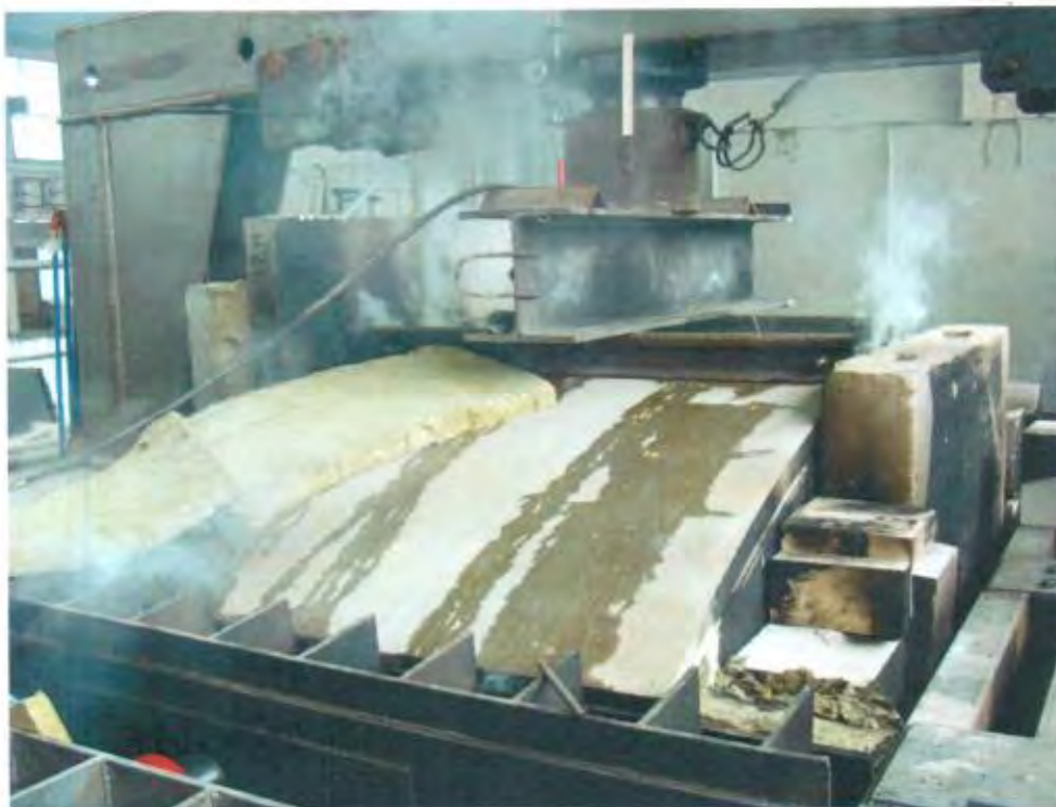
Рис. 5. 30-я мин испытания, выпаривание влаги на необогреваемой поверхности опытного образца № 1
