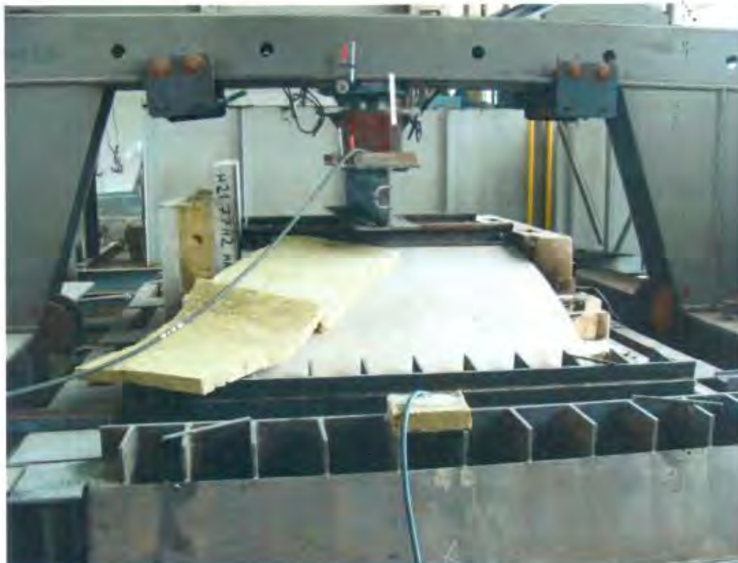
Рис. 2. Опытный образец бетонного блока тоннельной обделки, установленный на огневую камеру испытательной установки с приложенной статической нагрузкой в соответствие с проектно-расчетной схемой. На фотографии представлена система распределения нагрузки, гидравлический домкрат системы нагружения и стальная рама для восприятия нагружающего усилия.
