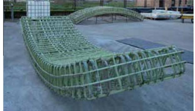
Fig. 3. GFRP cage.
