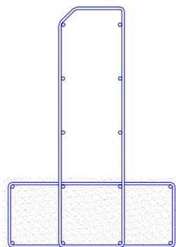
Il pannello da corrisponde esattamente ad un modulo costituito da 16 canne poste ad interasse 150 mm (vuoto/pieno 65/85) con spazi di attesa pari a 32.5 mm.
