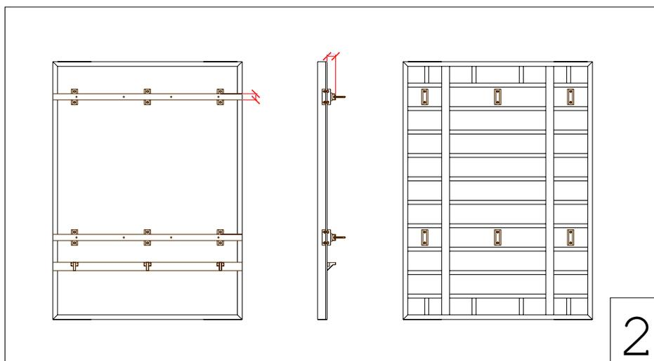
Ad ogni profilo di appoggio sono presaldati 4 perni M16\*120 che serviranno al serraggio delle canne attraverso un altro profilo a C che andrà successivamente ad impacchettare l'insieme.
