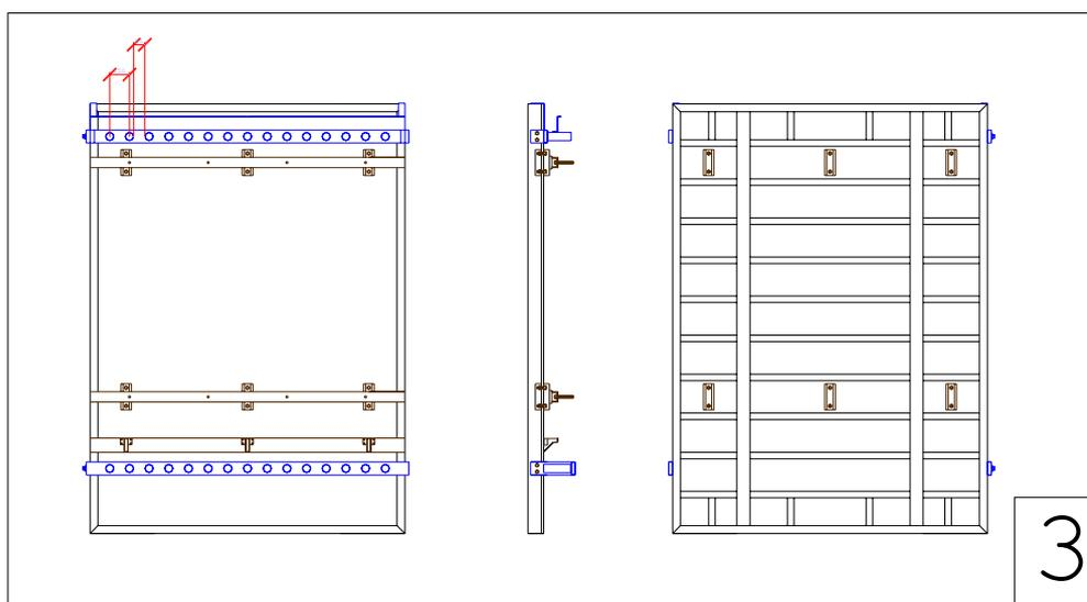
Il telaio a pettine superiore ha il profilo di collegamento posto dal lato della cassaforma e ad essa riappoggia. Quello inferiore, viceversa ha il profilo di collegamento in modo che sulla cassaforma appoggino i tubi distanziatori da 65 mm di diametro. (questo per consentirne lo smontaggio dopo il fissaggio delle canne)
