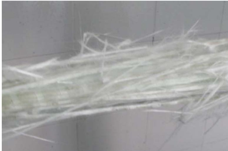
**Figura 1 - Dettaglio rottura per barre da 20 mm**
