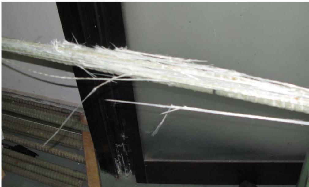
**Figura 2 - Tipica rottura per barre da 30 mm**
