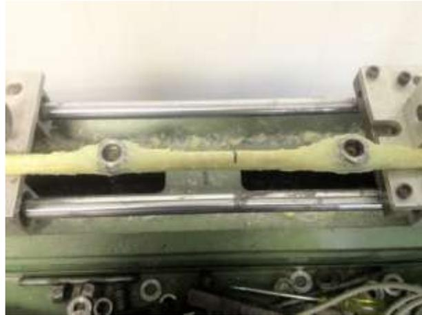
**Fig. III.27** – Predisposizione base di lettura LVDT
