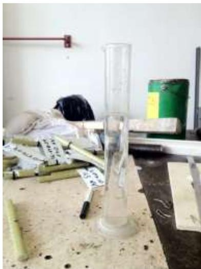
**Fig. III.37** - Tubo di vetro impiegato per la stima del diametro equivalente
