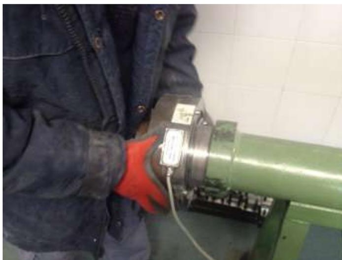
**Fig. III.26** –Posizionamento cella di carico
