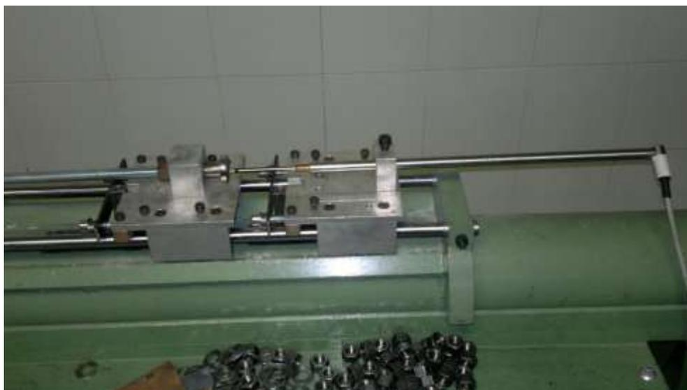
**Fig. III.30** - Predisposizione basamento ospitante LVDT
