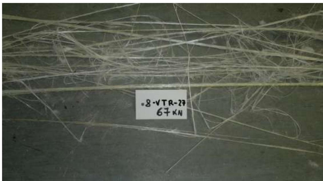
**Fig. III.34** - Tipica modalità di crisi delle barre del diametro D8
