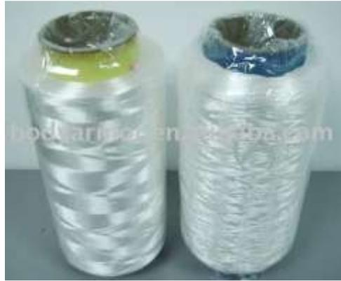
Fig. I.7- Tipici rotoli di fibre di vetro
