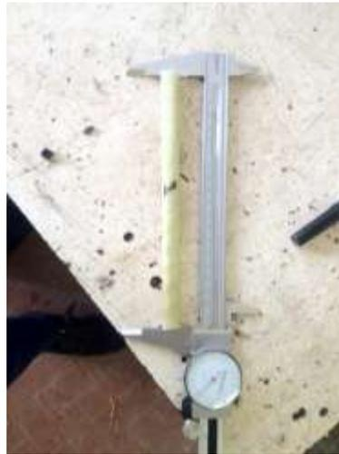
**Fig. III.36** - Stima della lunghezza del campione di barra
