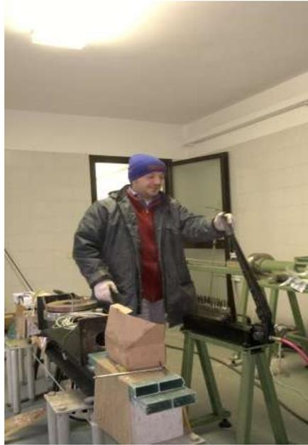
**Fig. III.31** – Applicazione degli incrementi di carico
