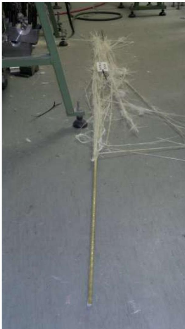
**Fig. III.35** - Tipica modalità di crisi delle barre del diametro D8
