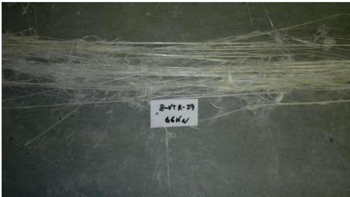
**Fig. III.33** - Tipica modalità di crisi delle barre D8
