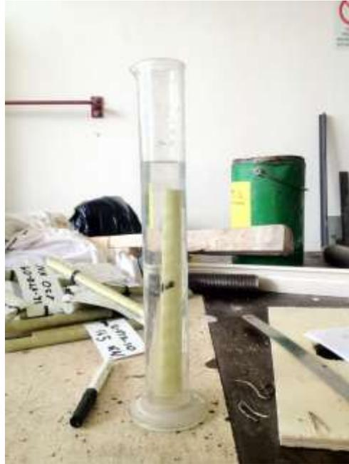
**Fig. III.38** - Immersione della barra nel tubo di vetro impiegato per la stima del diametro equivalente
