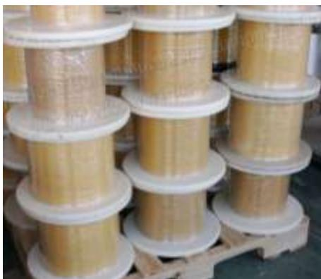
**Fig. I.10** - Tipici rotoli di fibre aramidiche
