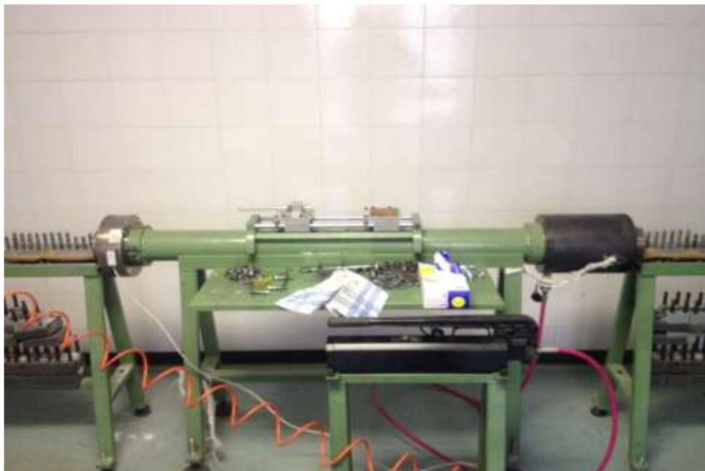
**Fig. III.25** –Set-up impiegato per test di trazione su barre in FRP
