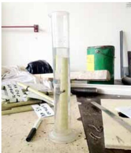
**Figura 4.3** – Immersione di barra nel tubo di vetro impiegato per determinazione di diametro equivalente.
