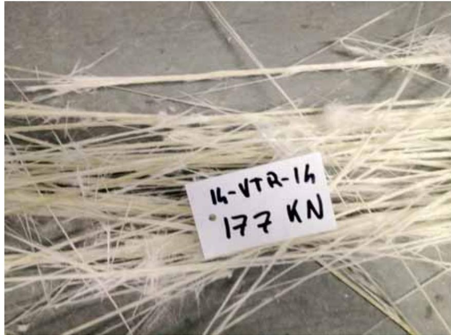
**Figura 4.6-**Tipica modalità di crisi delle barre del diametro 14mm.
