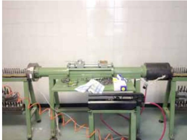
**Figura 3.5** –Set-up impiegato per test di trazione
