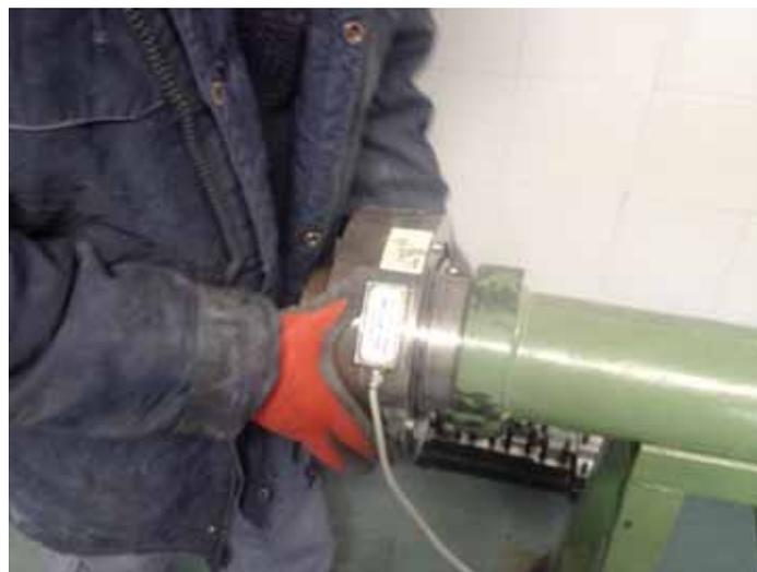
**Figura 3.6** –Posizionamento cella di carico.
