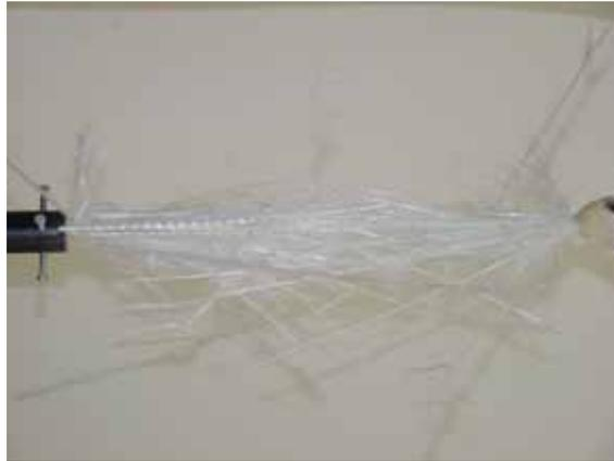
**Figura 3.3** – Tipica modalità di rottura delle barre dal diametro 10mm
