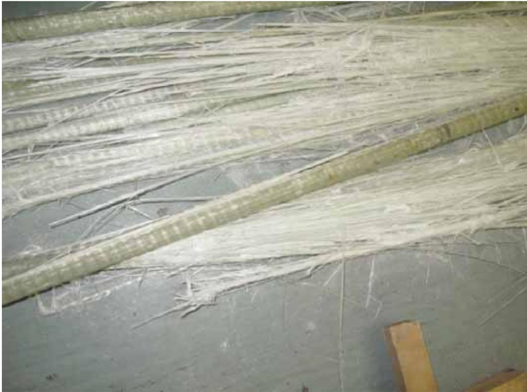
**Fig. 2.1** – Modalità di rottura di una barra di VTR
