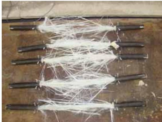
**Figura 3.4** – Tipica modalità di crisi dei 5 provini testati
