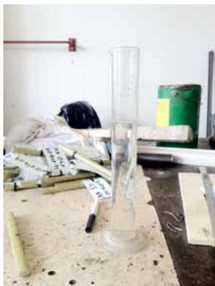
**Figura 4.2** – Tubo di vetro graduato impiegato per la stima del diametro equivalente
