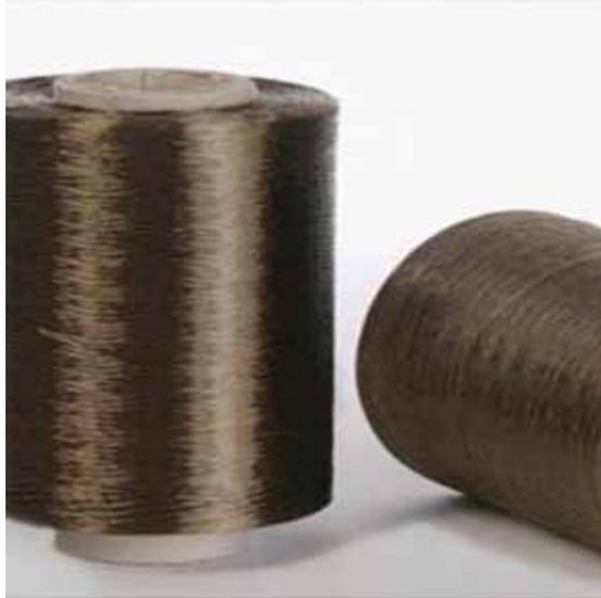
**Fig. 1.8**– Rotoli di fibre basaltiche
